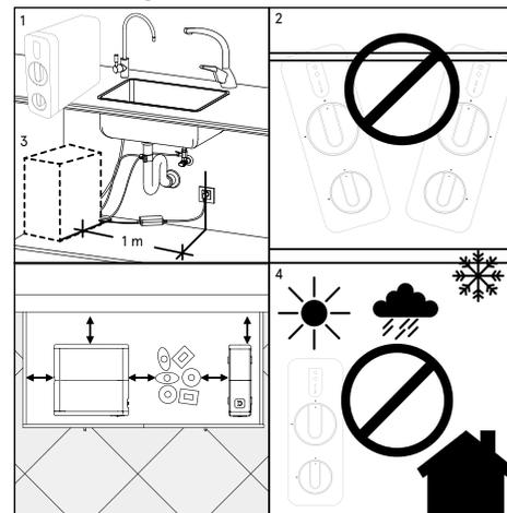
**¡ATENCIÓN:** Los equipos no deberán ser instalados al lado de una fuente de calor o recibiendo directamente un flujo de aire caliente sobre ellos.
