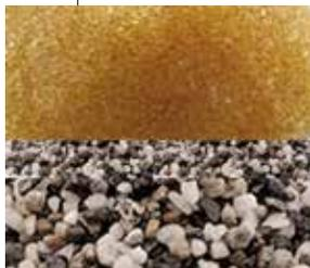
Base de sílex de diferentes granulometrías, óptima distribución del flujo de agua mejorando el proceso de regeneración.
