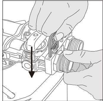
7. Debe medir, cortar y montar holgadamente la tubería y los accesorios desde la tubería de suministro principal de agua hacia la entrada y la salida de la válvula del descalcificador. Procure mantener las sujeciones todas juntas, y las tuberías encuadradas y rectas. Compruebe que el agua fluye desde la tubería hacia la entrada del descalcificador.
