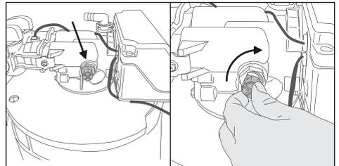
A continuación se debe medir la dureza del agua de salida del sistema y comprobar que se ajusta a los valores deseados. Si no fuera así, variar el regulador y volver a comprobar.
