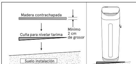
**! ATENCIÓN:** no coloque cuñas directamente debajo del depósito de sal. El peso del depósito cargado con agua y sal, puede hacer que el depósito se parta contra la cuña.
