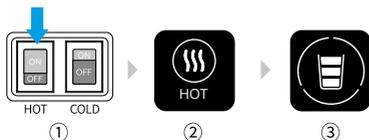
1. Para extraer agua caliente, el interruptor posterior HOT debe estar en posición ON. El icono frontal se encenderá.
