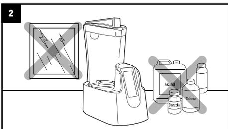
• Les équipements ne doivent pas être placés à côté d'une source de chaleur ni recevoir directement un flux d'air chaud (séchoir, lave-vaisselle, réfrigérateur, chauffage, chaudière, etc.).
