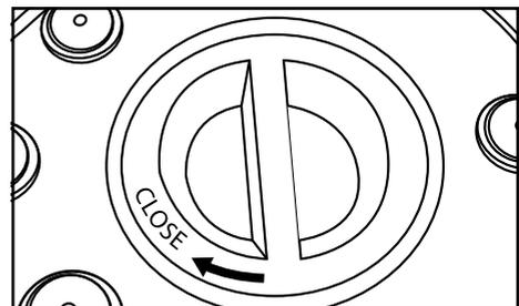
**!** **Nota:** Compruebe periódicamente que el depósito está lleno de agua. De lo contrario, rélleno. En el panel aparecerá el símbolo 'Lo', que indica un bajo nivel de agua. Este depósito permite el correcto funcionamiento del equipo.
