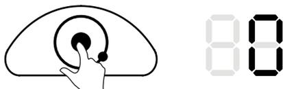
• **Selezione del tempo di trattamento:** Ogni volta che si preme il pannello, sullo schermo appare un tempo di idrogenazione e si accende anche un LED blu. È possibile selezionare tra 5, 10, 20, 30 o 0 minuti, quest'ultimo indica lo stato di riposo.
