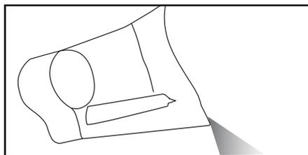
Per rimuovere le tracce di acqua dal filtro dell'ozono, rimuovere il filtro deozonizzatore e inclinare la brocca per far uscire l'acqua.
