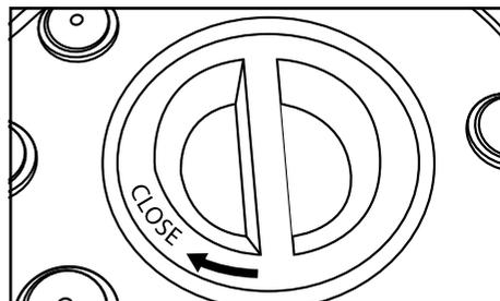
**!** **Nota:** Controllare periodicamente che il serbatoio sia pieno d'acqua. Altrimenti, riempirlo. Il simbolo "Lo" apparirà sul pannello: indica un basso livello d'acqua. Questo serbatoio consente il corretto funzionamento del dispositivo.
